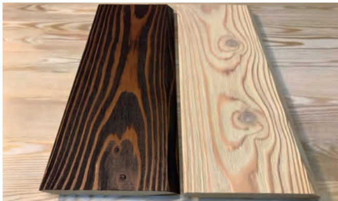
Рис. 7.1 Образцы сосны до обработки (справа) и после плазменной обработки (слева)
